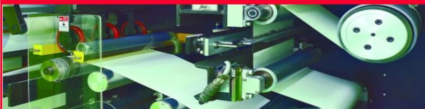
セラミック材料を薄いシートに成形し、何層にも積み重ねる技術を鍛え上げてきました。この高いレベルの技術でお客様の期待に応えています。
